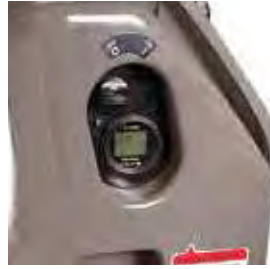
GÖSTERGE (çalışma saati ve akü şarj durumu) INDICATOR (operation hour and charge level)
